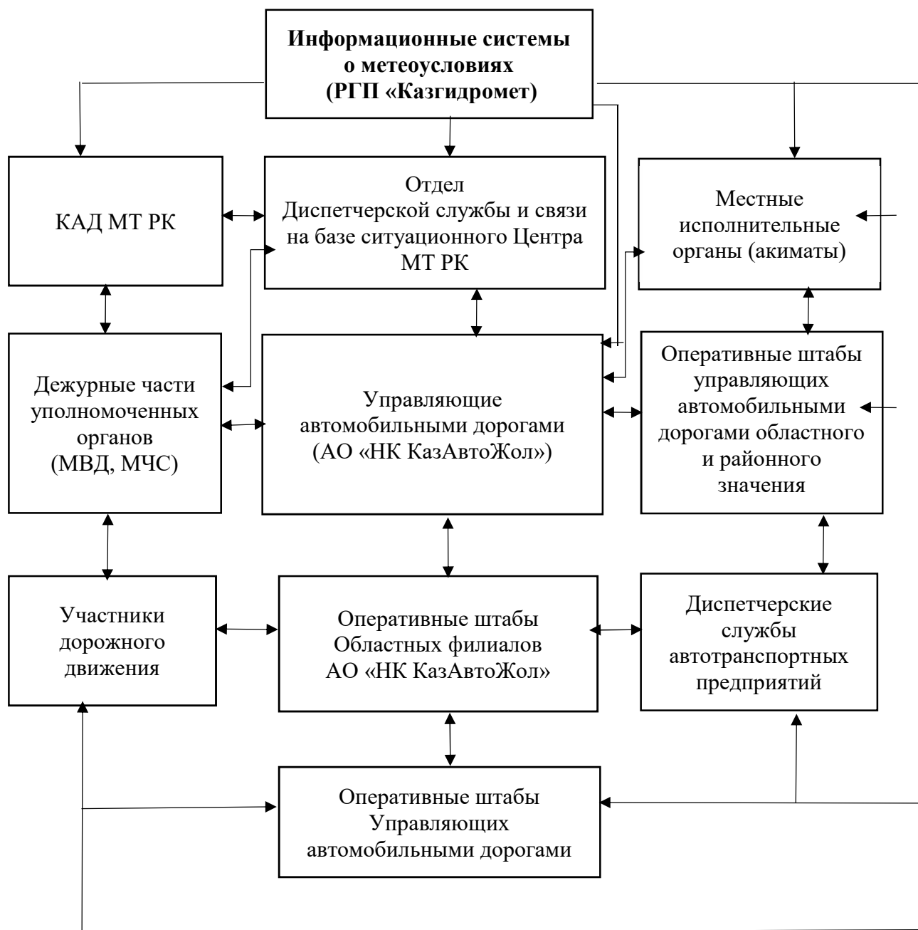
Рисунок Б.1 - Схема сбора, приема и передачи информации о метеоусловиях
